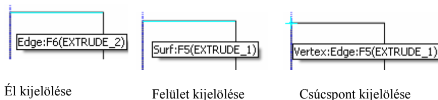
2.36. ábra A referencia kijelölése / F5 – a modellfa 5. eleméhez tartozik /
